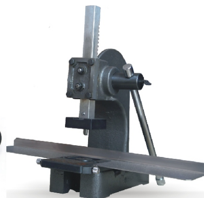
Praska do samodzielnego montażu przelotek, wycinania otworów.
